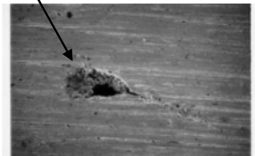
貫通欠陥部1表面観察結果
