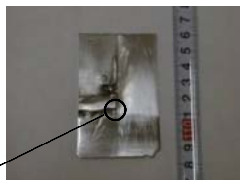
調査試験片（裏面）〔埋込金物、下地材を取り外した状態〕
